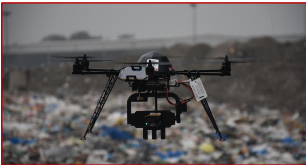
Drone utilisé : Hexacoptère de 1.2m d'envergure
