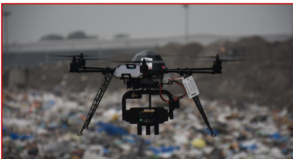
Drône utilisé : Hexacoptère de 1.2m d'envergure
