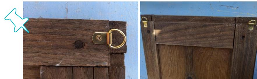
**Important : réaliser cette étape avant de fixer les crochets sur la face avant du panneau.** Positionner les anneaux étriers au dos du panneau de façon à pouvoir l'accrocher sur un mur. Mesurer pour bien équilibrer et ne pas les placer trop au bord car le bois y est plus fragile et casserait.
