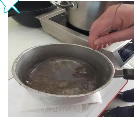
Laisser tremper pendant une minute la mèche dans la cire fondue et la repêcher par le boulon avec le fil de fer tordu en hameçon.
