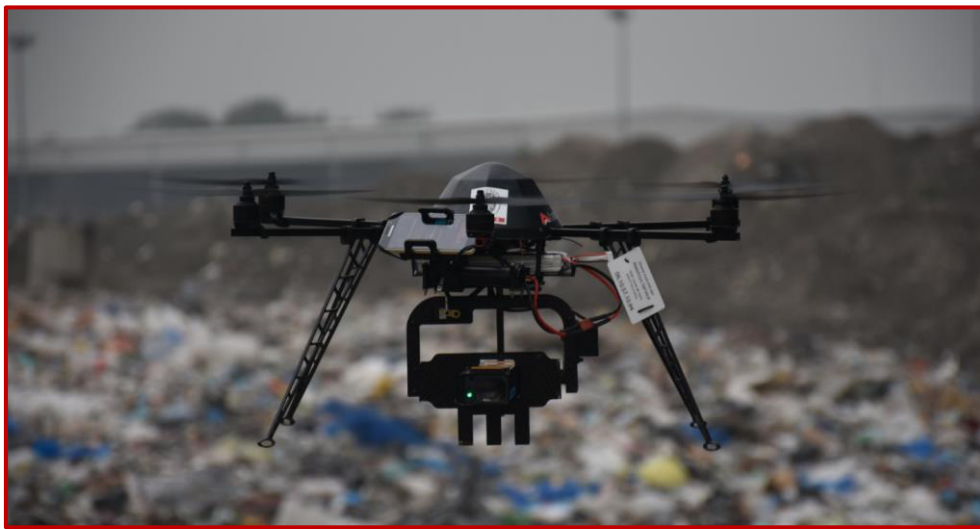
Drône utilisé : Hexacoptère de 1.2m d'envergure
