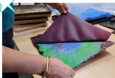
Créer des plaques fines avec les granulés de plastique en chauffant ces derniers dans une presse à chaud.
