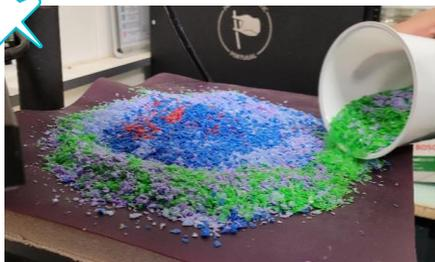
Broyer les bouchons de plastiques préalablement lavés et triés par couleur grâce à la broyeuse Precious Plastic.
