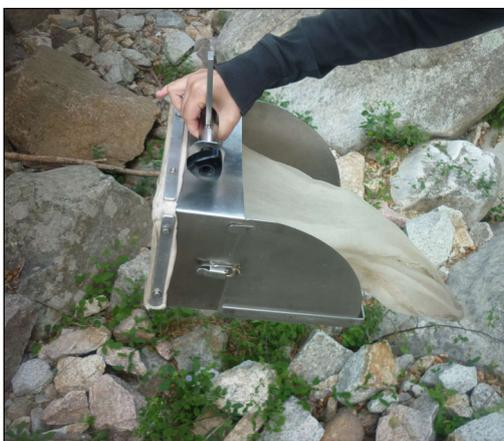
*Figure 1. Échantillonneur de type Surber.*
