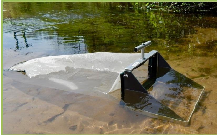
Figure 1. Échantillonneur de type Surber.
