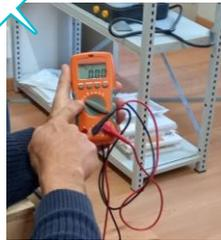
Vérifier à l'aide du voltmètre si le montage est conducteur du courant
