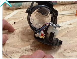
Trouver les soudures dessoudées (à ressouder ou coller) ou fils électriques déboîtés (dévisser les cosses puis reboîter le fil et resserrer les cosses)
