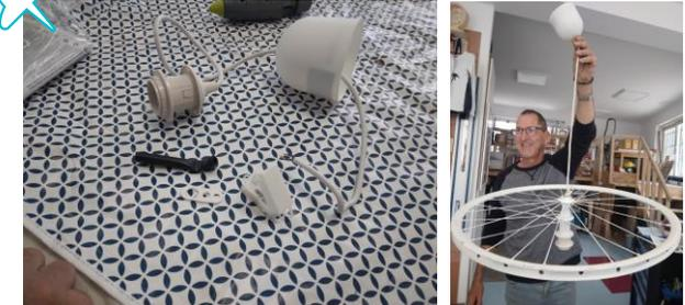
Poser le fil électrique en passant le fil dans le trou central de la roue
