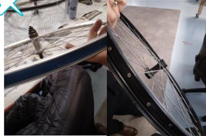
Démonter le moyeu de la roue de vélo et nettoyer la roue à l'aide d'un chiffon.
