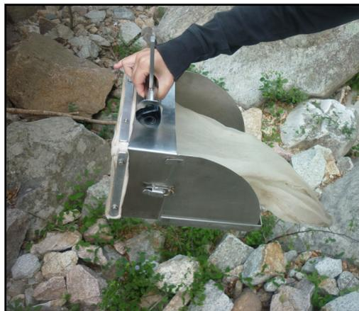
Figure 1. Échantillonneur de type Surber.
