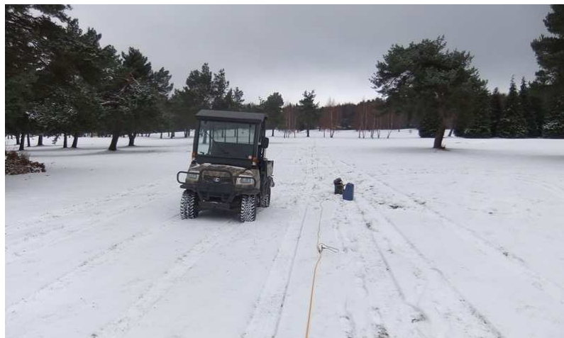
Figure 4 : Panneau électrique terrestre -flûte de 155m – 32électrodes.
