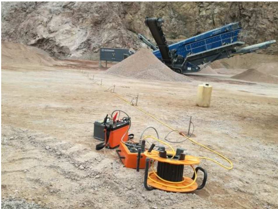
Matériel de mesure de panneau électrique in situ.
