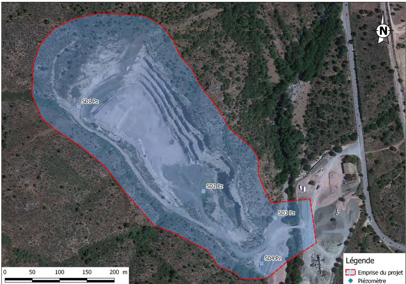
Figure 23 : Plan d'implantation des piézomètres (source : BURGEAP sur fond Géoportail)
