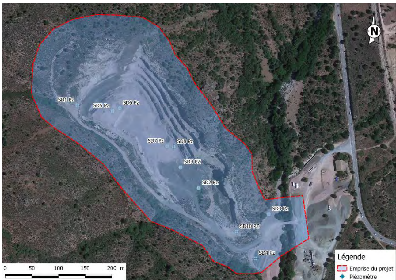
Figure 25 : Plan d'implantation des piézomètres (source : BURGEAP sur fond Géoportail)
