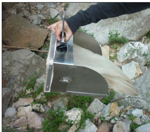
Figure 1. Échantillonneur de type Surber.
