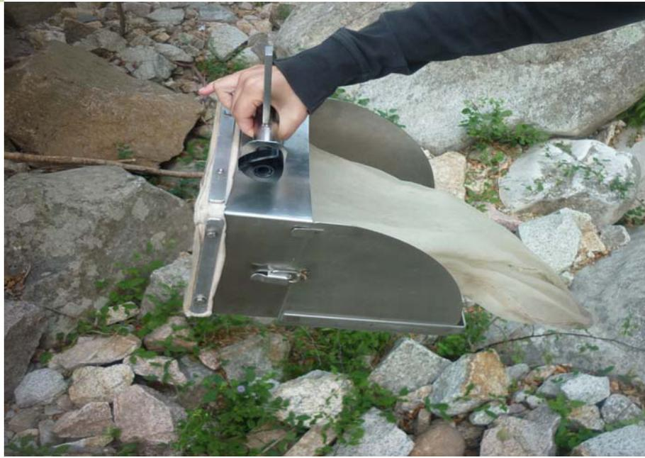
Figure 1. Échantillonneur de type Surber.
