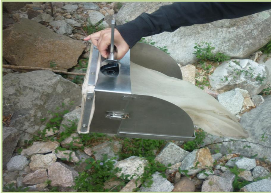
Figure 1. Échantillonneur de type Surber.
