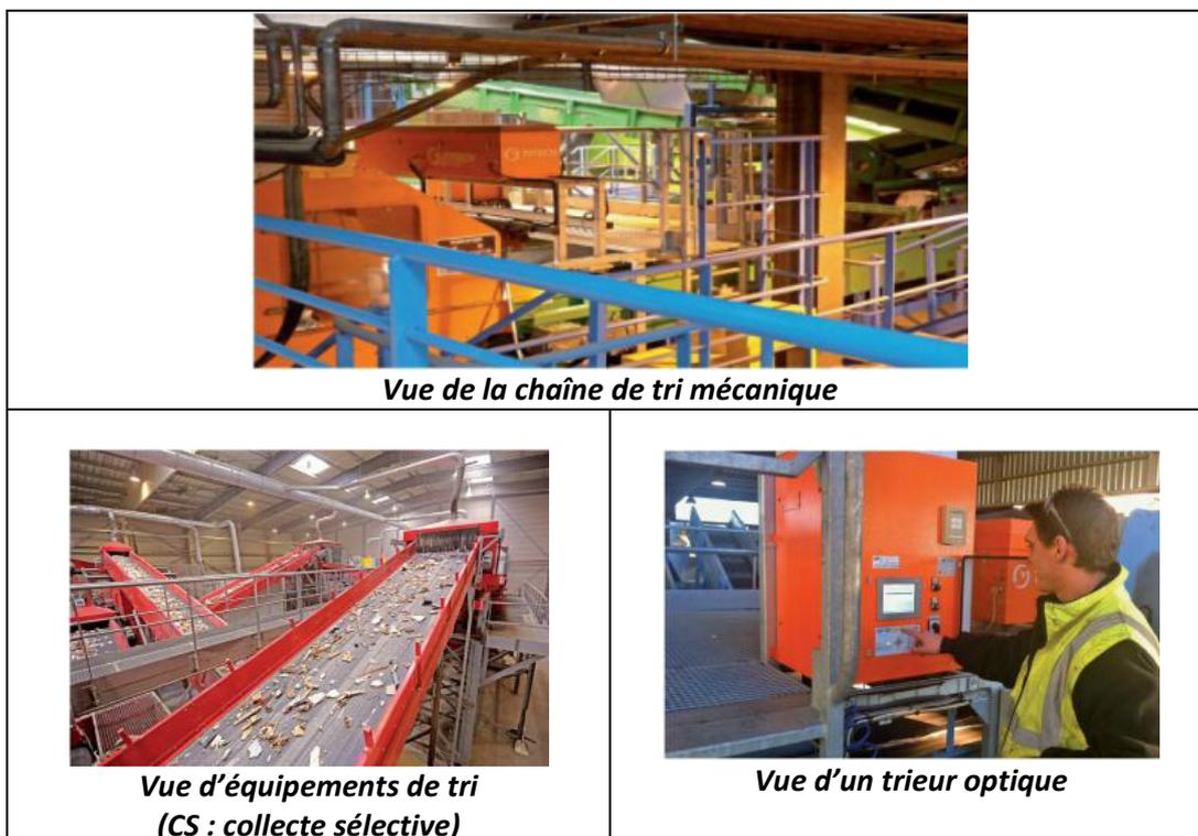
Figure 22 : Illustrations de chaînes de tri pour la valorisation matière des OMr et CS
