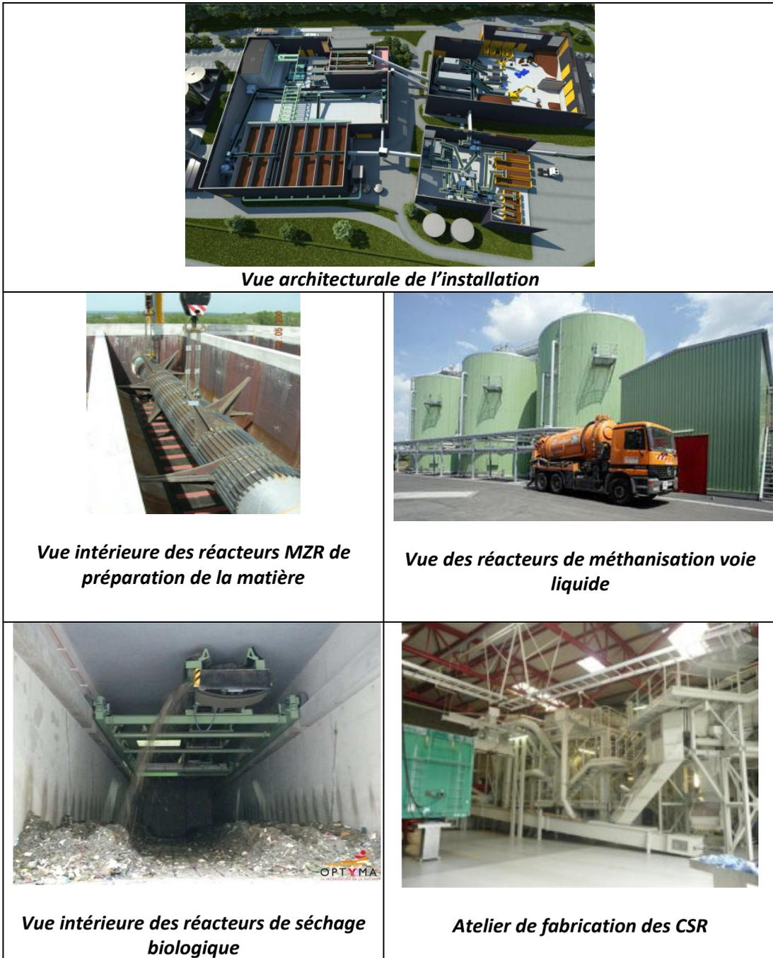
Figure 20 : Illustrations des ateliers d'une installation de tri et de valorisation OPTYMA®
